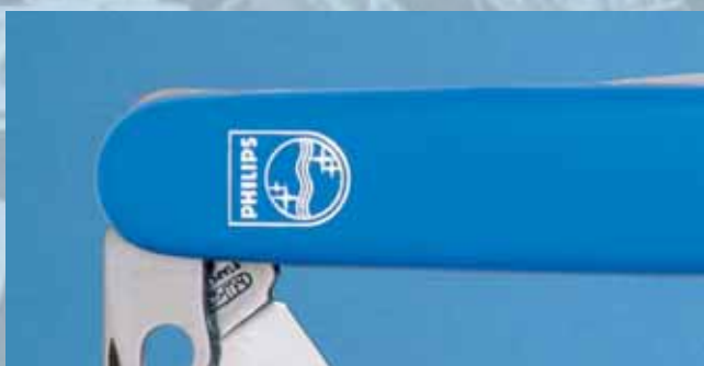
Hlubková ražba do střenky | Relief stamping on knife handle
